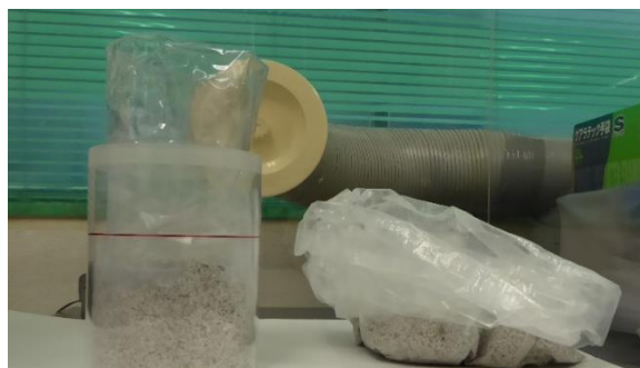
(d) Fill the sample up to the scale on the Marinelli-type vessel.
