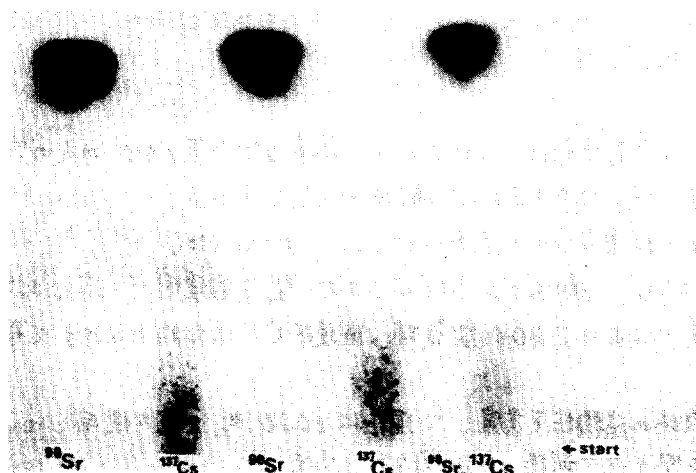
写真10, 一次元薄層クロマトグラフによる放射性の ^{90}\text{Sr} , ^{137}\text{Cs} 吸着・固定能 展開剤: 0.5N塩酸, 展開時間20分間 ^{90}\text{Y} 減衰後のオートラジオグラム
