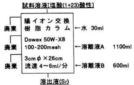
図1 イオン交換分離操作(改訂法)
