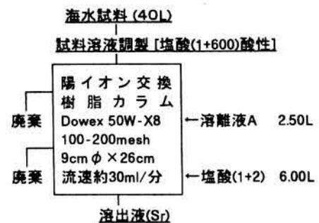
図2 海水試料の前処理濃縮操作(改訂法)
