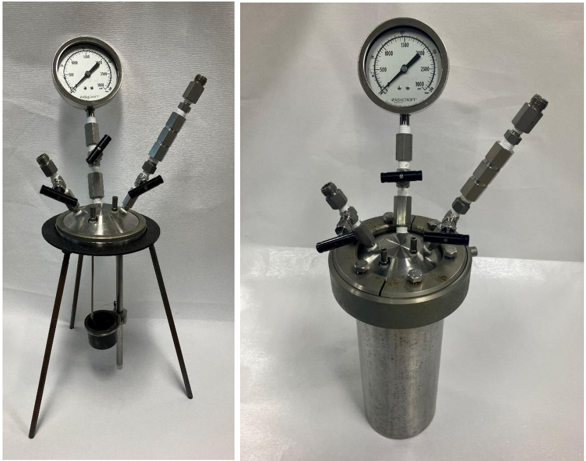
図4-2 迅速試料燃焼装置の写真(左は組み立て前、右は組み立て後)
