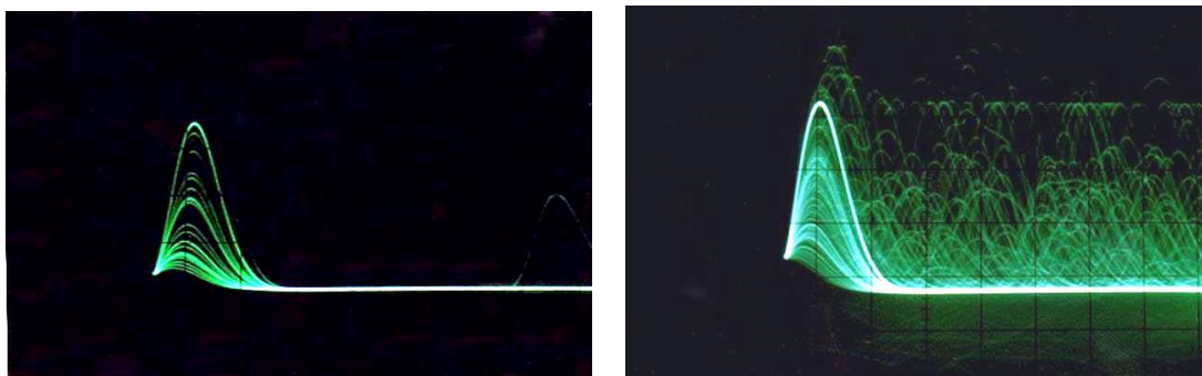
図 E.2 オシロスコープによる波形観察画面 (左図：デッドタイム 5%以下、右図：デッドタイム 10%以上)
