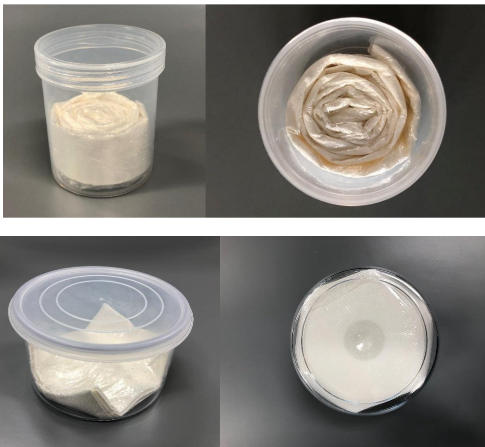
図 4-4 長尺ろ紙 (78 mm×700 mm) の 6 時間分を充填した例 (上：集じん面が底に近づくよう細長く折ってロール状に U-8 容器に充填した例、 下：集じん面が中心になるよう 1 時間分ごとに重ねて折って V-9 容器に充填した例)
