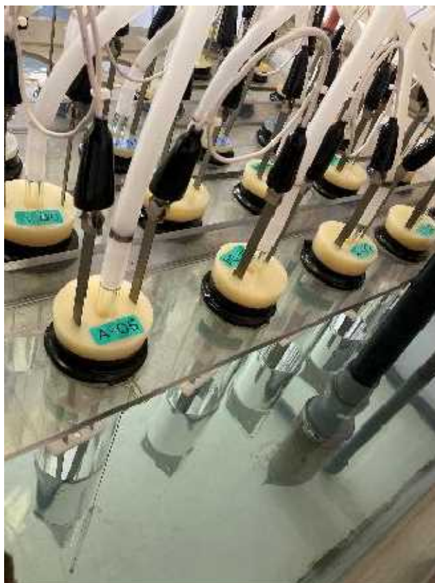
図 2.6 金属電極を用いた電解濃縮の様子
