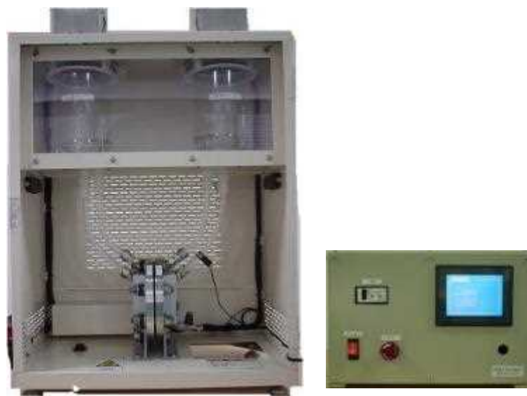
図 2.9 固体高分子電解濃縮装置の外観
