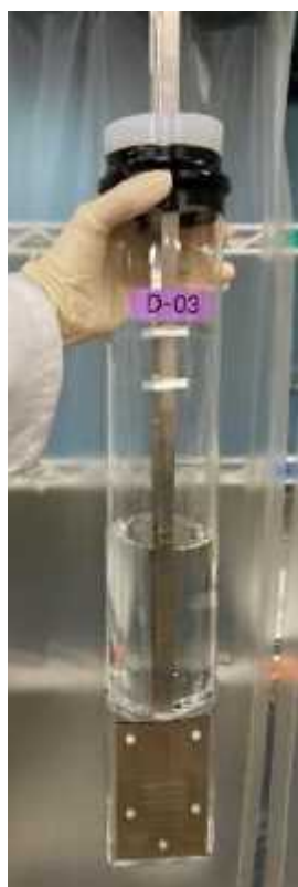
図 2.5 金属電極を用いた電解濃縮の電解セル（電解前）
