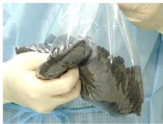
写真 2-17 試料の搅拌・混合
