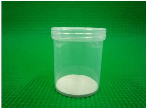
写真 2-4 小型容器への試料の充填
