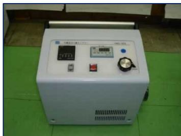
写真 2-3 ロウボリウムエアサンプラの例
