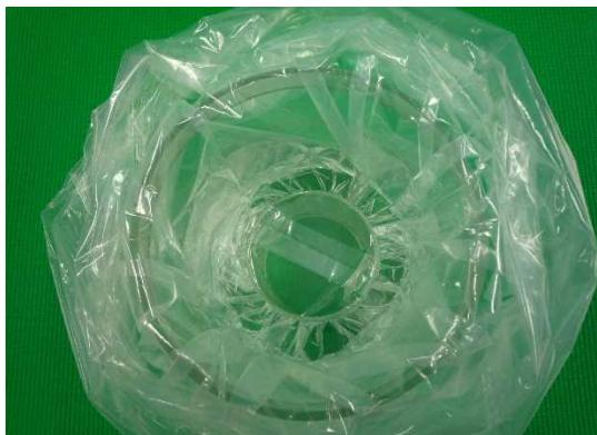
写真 2-8 マリネリ容器への試料の充填
