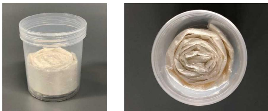
写真2-7 6時間分に切り取った長尺ろ紙を充填した例
